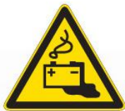
Pericolo batterie in fase di carica W026
