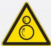
Attenzione rulli rotanti/ pericolo di trascinamento W025
